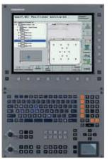
Fräs- und Bohrmaschinen sowie für Bearbeitungszentren. Sie hat eine integrierte digitale Antriebsregelung mit integriertem Umrichter. Bei Bearbeitungen mit hohen Geschwindigkeiten erzielen Sie so eine hohe Konturtreue des gefertigten Werkstücks. Die iTNC 530 steuert bis zu 13 Achsen und Spindel. Die Satzverarbeitungszeit beträgt 0,5 ms. Als Programmspeicher dient eine Festplatte. In der Hardware-Option mit zwei Prozessoren ist die iTNC 530 zusätzlich mit dem Betriebssystem Windows
